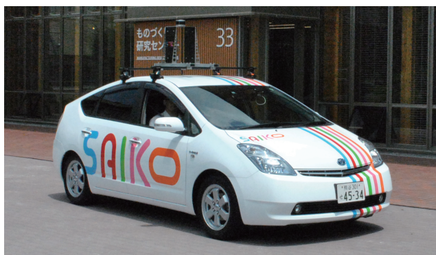
図2: 公道実証実験車両（トヨタ プリウス改造車）
