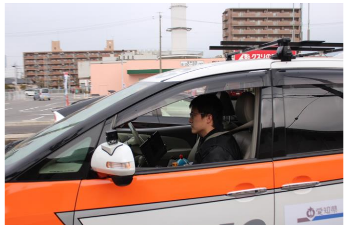
<写真2：運転席が無人の自動運転車の助手席で本学大学院生がシステム監視者を担当>
