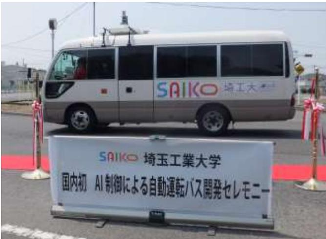
今回開発した自動運転バスの実験車両は、マイクロバス「リエッセII」をベースに「自動運転AI (AIPilot / Autoware\*)」を実装したものです。AIを本格的に導入して走行する自動運転バスのためバス専用レーンや走行規制をした特定のコースだけでなく、市街地の一般公道で走行を目指します。
