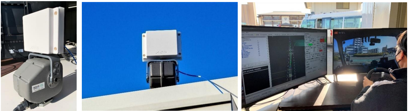
<写真：(左)と(中):ローカル5Gの基地局、(右):ローカル5Gによる自動運転バスの遠隔監視・操作写真>
