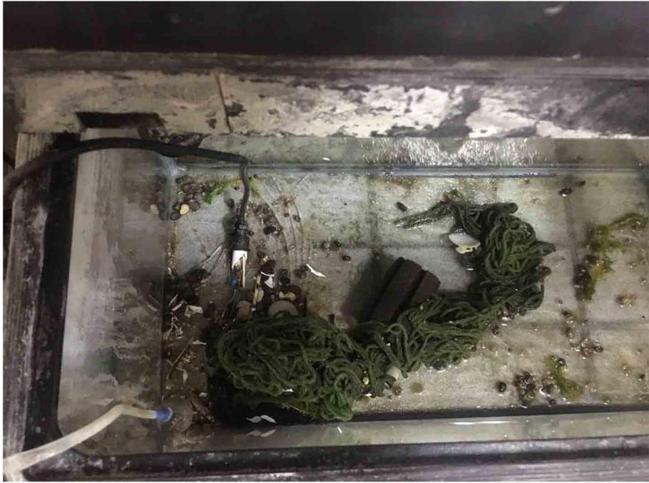
図 23. 破損したヒーター
