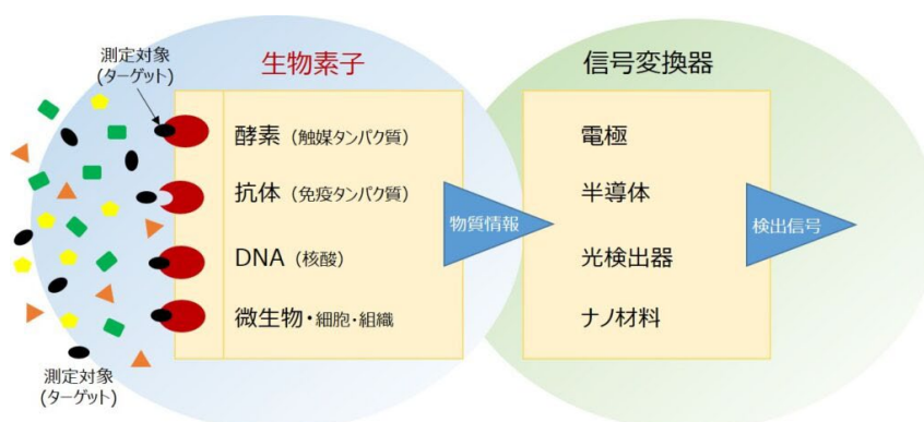
図1 バイオセンサーの原理・構成
