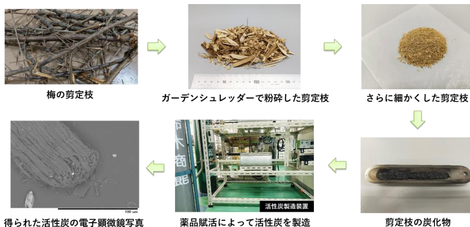
<写真②：梅の剪定枝から活性炭を作るプロセス>
