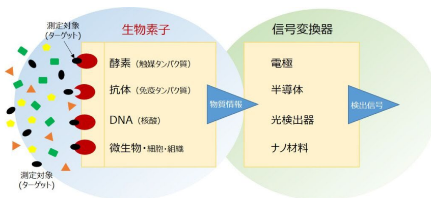
図1 バイオセンサーの原理・構成
