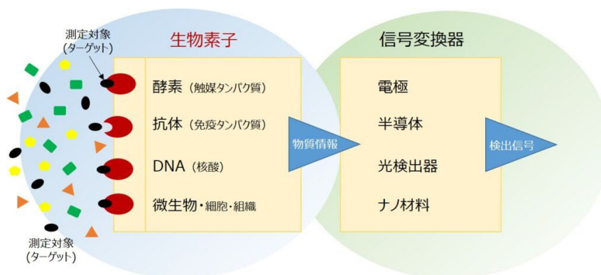
図1 バイオセンサーの原理・構成
