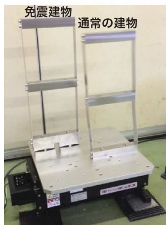
図1 免震装置の模型実験
