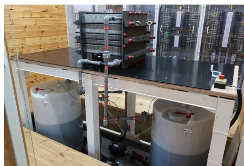
本学で実証実験中のレドックスフロー電池
