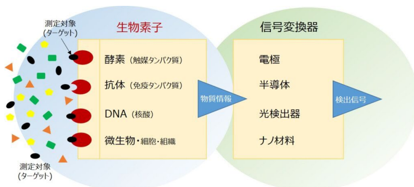
図1 バイオセンサーの原理・構成
