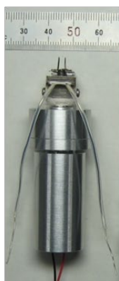
ピンセット型電動はんだごて装置
