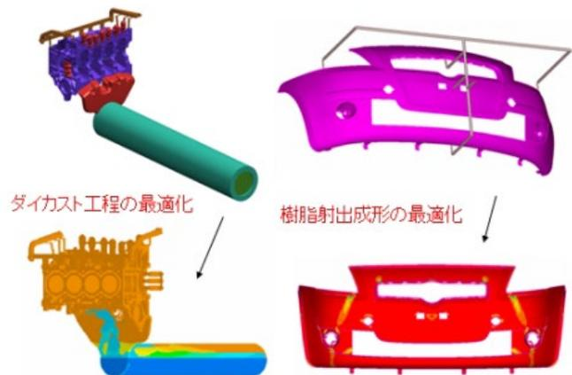
図 2. 生産工程の最適化応用事例
