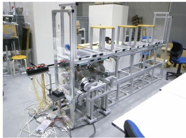
図2 鉄道車両の状態監視技術実験装置
