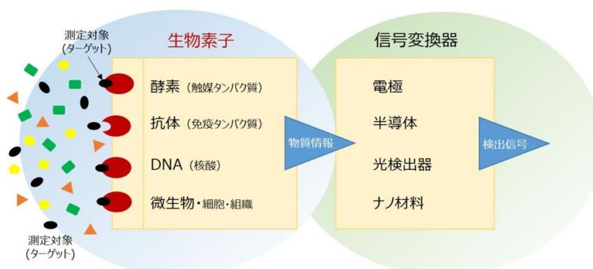
図1 バイオセンサーの原理・構成
