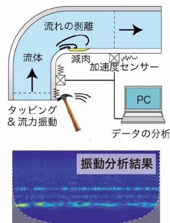
図3 配管の振動モニタリング
