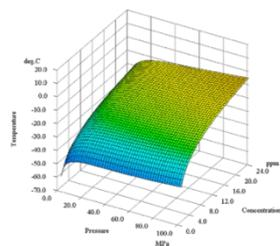
図 H<sub>2</sub>+H<sub>2</sub>O系の露点推算結果
