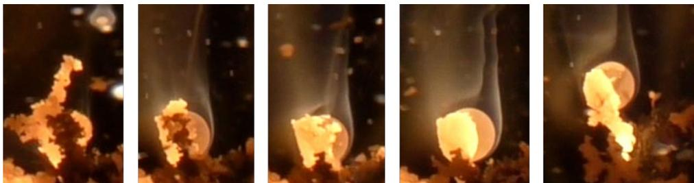
図 固体推進薬表面でのアルミニウム液滴の形成と燃焼の様子
