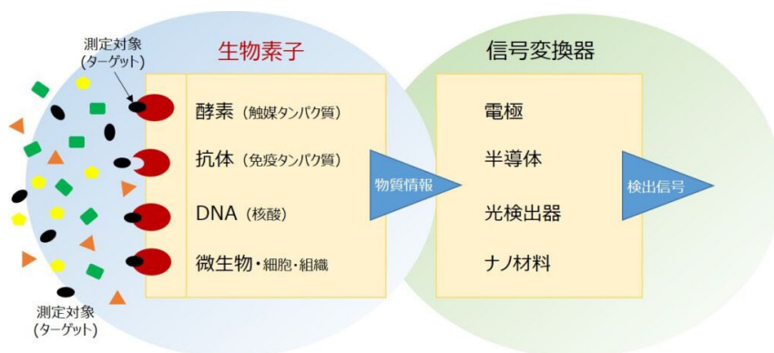
図1 バイオセンサーの原理・構成
