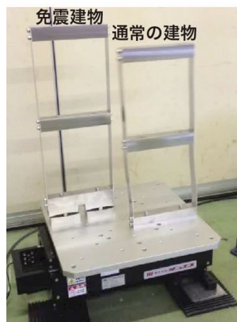
図1 免震装置の模型実験
