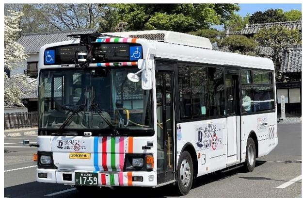
写真2（右）：新規開発された大型自動運転バス
